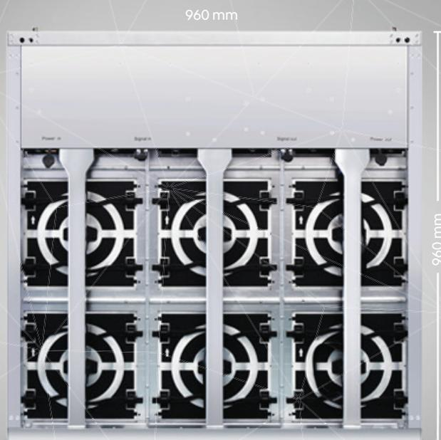
Durch die modulare Bauweise der BE-LED-Videowalls können diese zu beliebigen Bildschirmgrößen, je nach Anforderung, zusammengestellt werden. Verschiedene Pixelabständen sorgen, je nach Einsatzgebiet, für das perfekte Bild. So sollten beispielsweise in Innenräumen LED-Walls mit engeren LED-Raster verwendet werden, da der Betrachtungsabstand hier in der Regel geringer ist.
